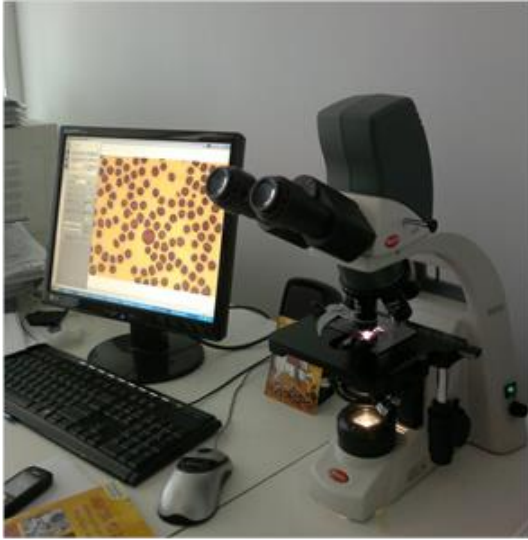
სურ.17. ციფრული მიკროსკოპი Motic BA 310, Abaxis-ის წარმოების ავტომატური ბიოქიმიური VetScan VS2 და ჰემატოლოგიური VetScan ანალიზატორები დელფინარიუმის კლინიკურ-დიაგნოსტიკურ ლაბორატორიაში
