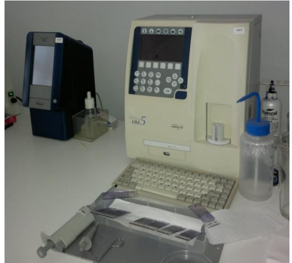
სურ.17. ციფრული მიკროსკოპი Motic BA 310, Abaxis-ის წარმოების ავტომატური ბიოქიმიური VetScan VS2 და ჰემატოლოგიური VetScan ანალიზატორები დელფინარიუმის კლინიკურ-დიაგნოსტიკურ ლაბორატორიაში
